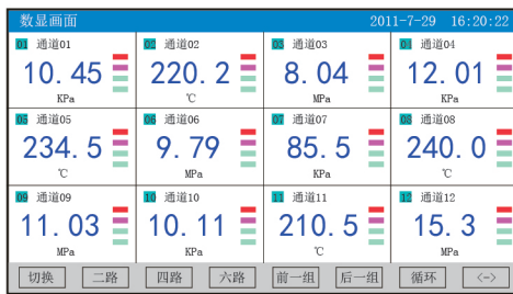
数显画面：显示实时测量值，同时还可显示通道位号、工程单位及报警状态等信息
