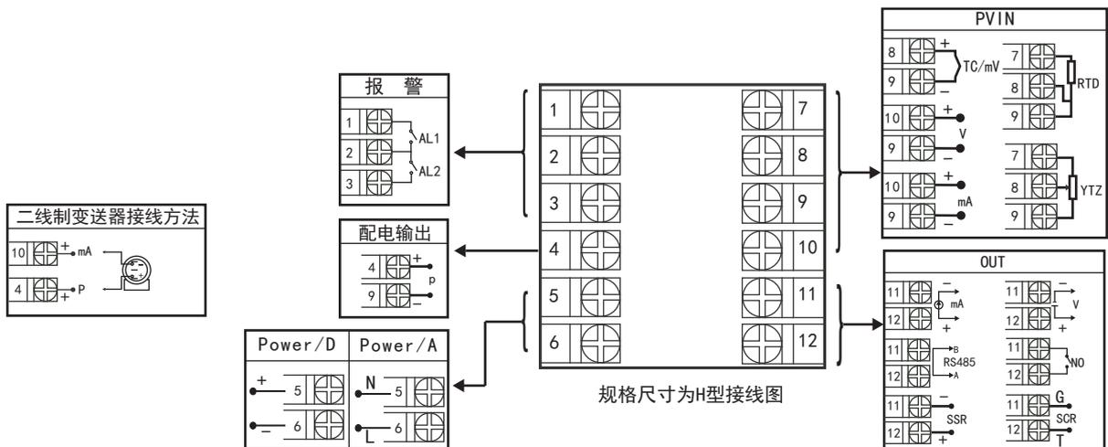
★注：上述接线图中在同一组端子标有不同功能的，只能选择其中一种功能。如RS485通讯功能和控制输出功能在同一组OUT接线端子上，只能选择一种。若两者需同时存在时，控制输出只能选择开关量输出且接线端子在AL2上。
